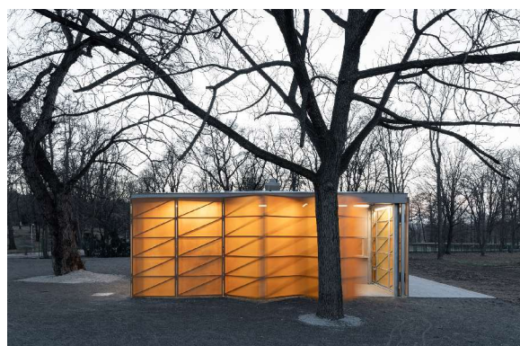
lehký shrnovatelný přístřešek lehká pozinkovaná nebo dřevěná konstrukce se shrnovatelnými bočnicemi krytovaná sklolaminátem
